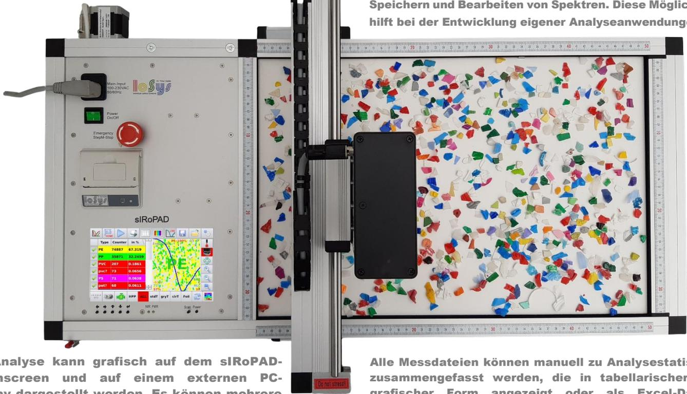
Die Analyse kann grafisch auf dem siRoPAD-Touchscreen und auf einem externen PC-Display dargestellt werden. Es können mehrere Messstatistiken erstellt werden. Mit Zoom-Funktionen ist es möglich, während und/oder nach der Messung an interessierenden Orten im Detail manuelle Gegenkontrollen in der Map durchzuführen.
